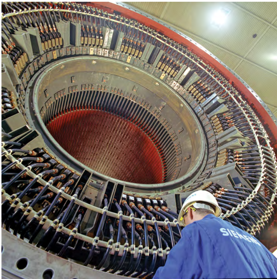
Figura 4-10. Estátor enfriado por agua de un generador sincrónico trifásico de una gran planta de fabricación en Muelheim, Alemania (© Siemens AG 2012, Todos los derechos reservados).
